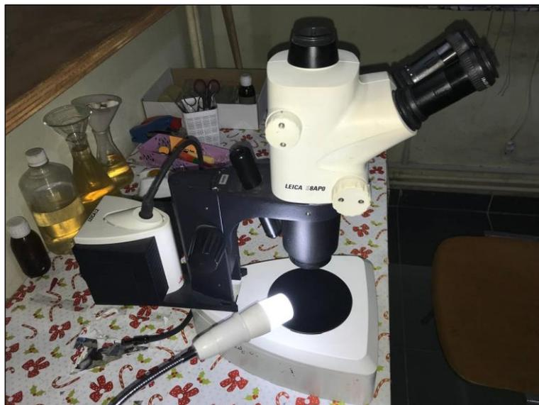
**Figure 41 :** Loupe binoculaire de marque « Leica » modèle « S8 AP0 ». (Laboratoire de Biosystématique et Ecologie des Arthropodes. Université Constantine 1) (Photo originale).
